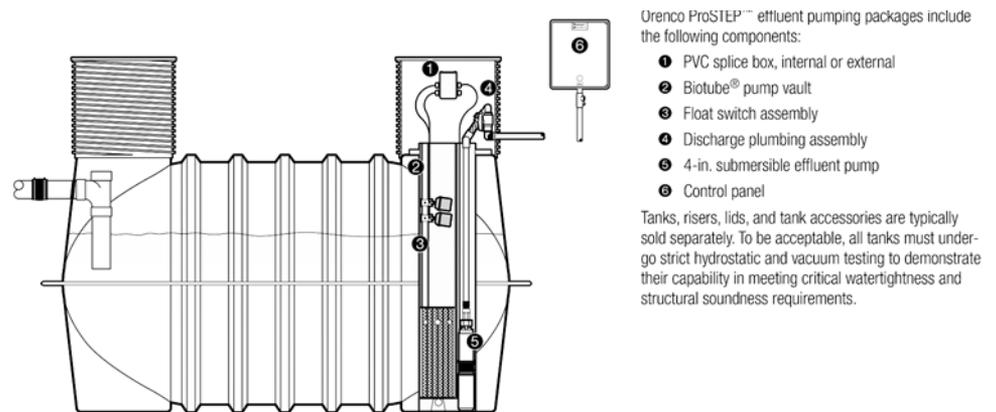
Figure 3. Effluent sewer septic tank effluent pumping package.
